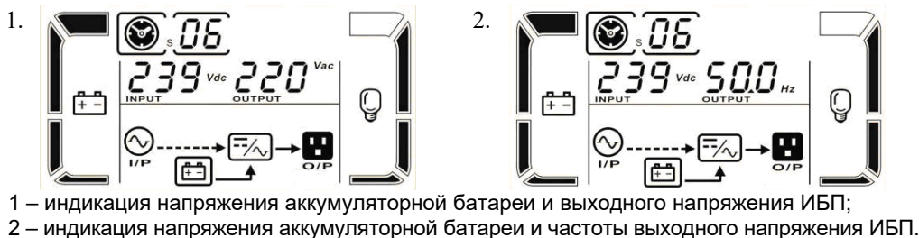
Рисунок 18 – Показания LCD-дисплея ИБП в режиме тестирования батарей
