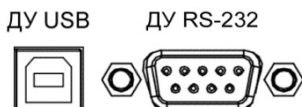
Рисунок 12 – Внешний вид последовательных портов USB и RS-232, расположенных на задней панели ИБП
