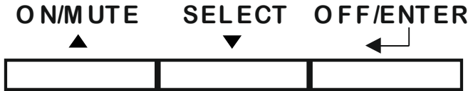
Рисунок 3 – Внешний вид кнопок управления ИБП
