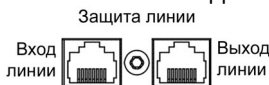
Рисунок 14 – Внешний вид розеток для подключения телефонной или факс - модемной линии, расположенных на задней панели ИБП
