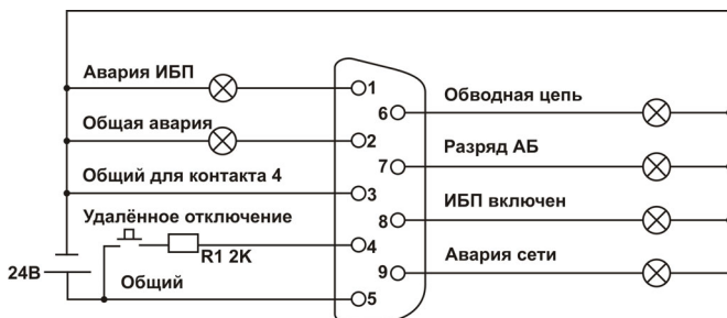
Рисунок 15 – Электрическая схема организации контроля и управления ИБП с электропитанием от источника постоянного тока напряжением +24 В
