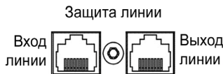
Рисунок 7 – Внешний вид розеток для подключения телефонной или факс - модемной линии, расположенных на задней панели ИБП
