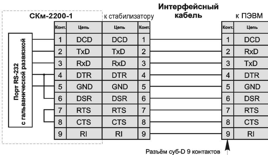
Рисунок 6 – Схема электрическая соединения стабилизатора с ПЭВМ
