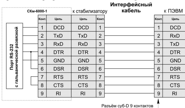
Рисунок 7 – Схема электрическая соединения стабилизатора с ПЭВМ
